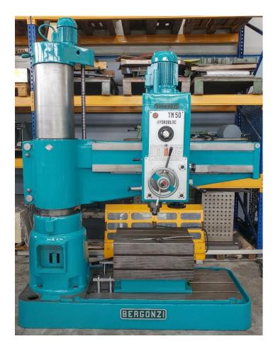
CAPACITA' DI FORATURA SU GHISA: 65 MM CAPACITA' DI FORATURA SU ACCIAIO: 50 MM
