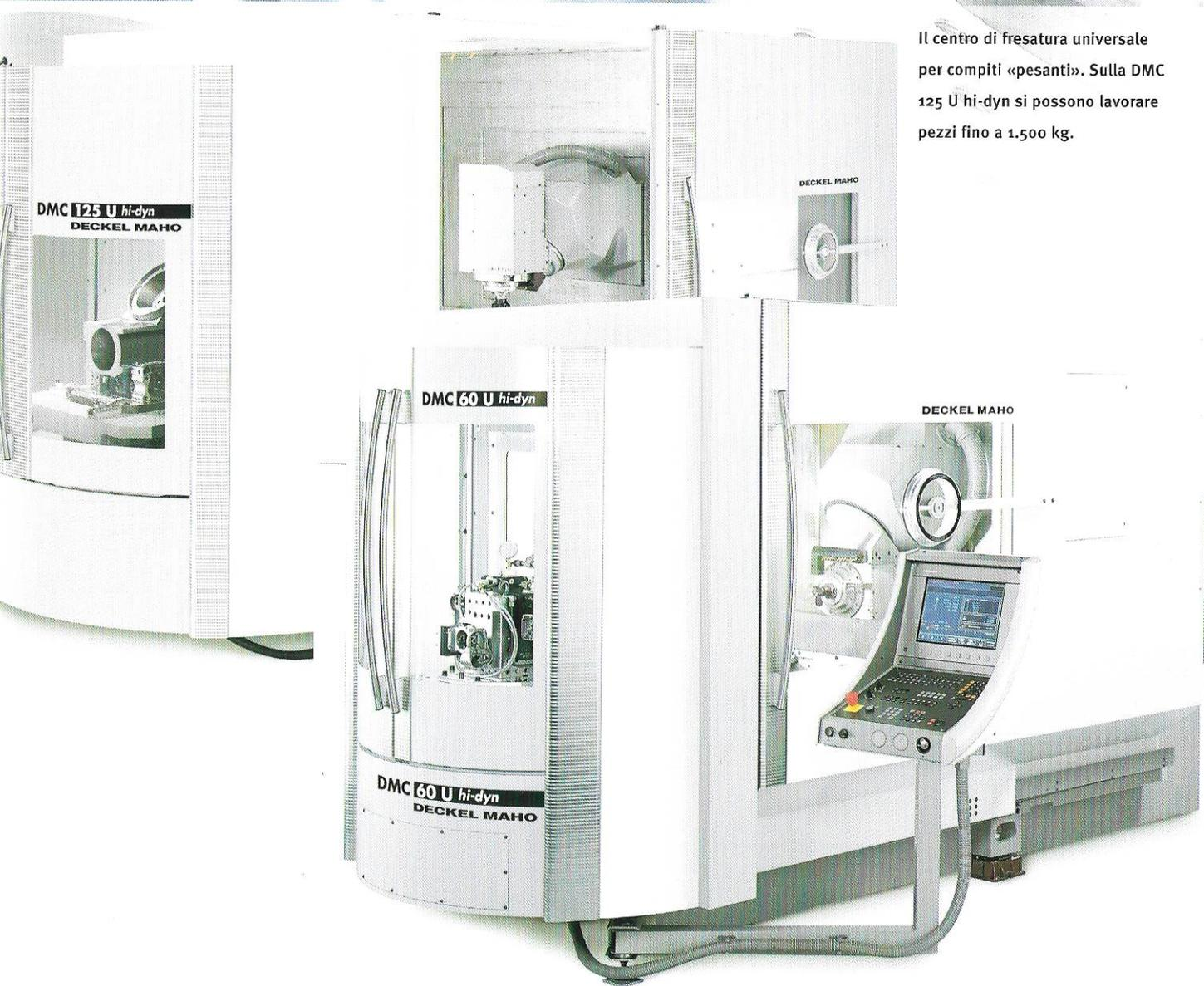
Il centro di fresatura universale per compiti «pesanti». Sulla DMC 125 U hi-dyn si possono lavorare pezzi fino a 1.500 kg.
