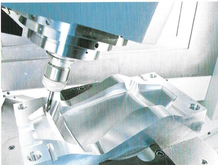
La testa brandeggiabile come asse B comandato consente la lavorazione con funzionamento simultaneo a 5 assi.
