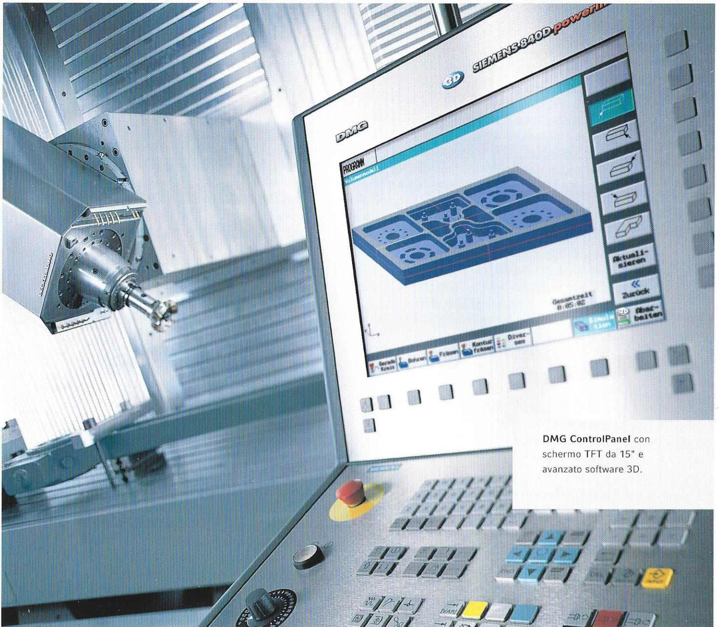
DMG ControlPanel con schermo TFT da 15" e avanzato software 3D.
