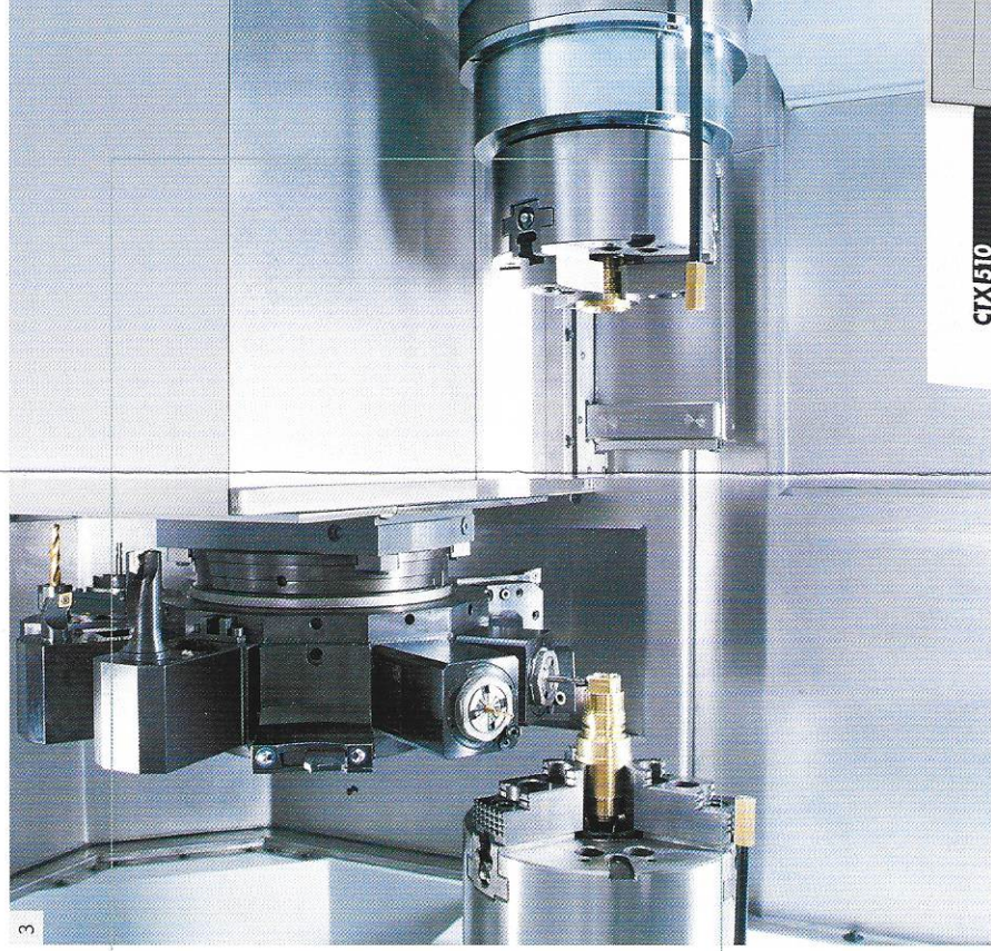
1| Elettromandrino integrato per elevata dinamica in accelerazione e decelerazione 2| Pannello di controllo orientabile DMG SlimLinePanel con Siemens 840D ShopTurn 3| Zona di lavoro con contromandrino
