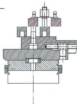
Dispositivo per cambiare la posizione radiale della torretta portautensile rispetto l'asse di rotazione oltre la corsa della slitta trasversale.
