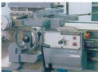
Comando a mezzo leva montato su carro. Per comando avanzamenti longitudinali e trasversali in lavoro e rapidi. Rapidi = 2700 mm/min
