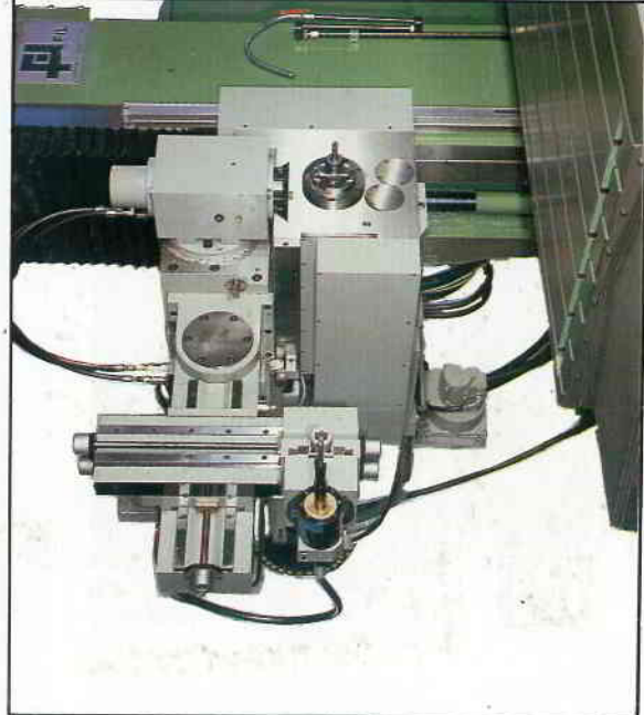
2° con rotazione di 90° del tastatore, lavorando con l'utensile orizzontale, per eseguire stampi di medie dimensioni in posizione verticale, per un facile deflusso del truciolo
