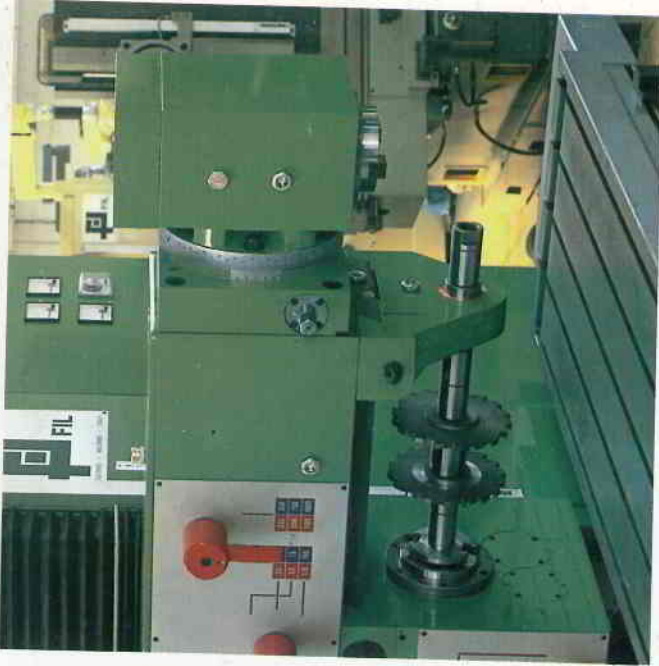
6 allo slittone si può applicare il supporto a sostegno del mandrino portafrese a disco
