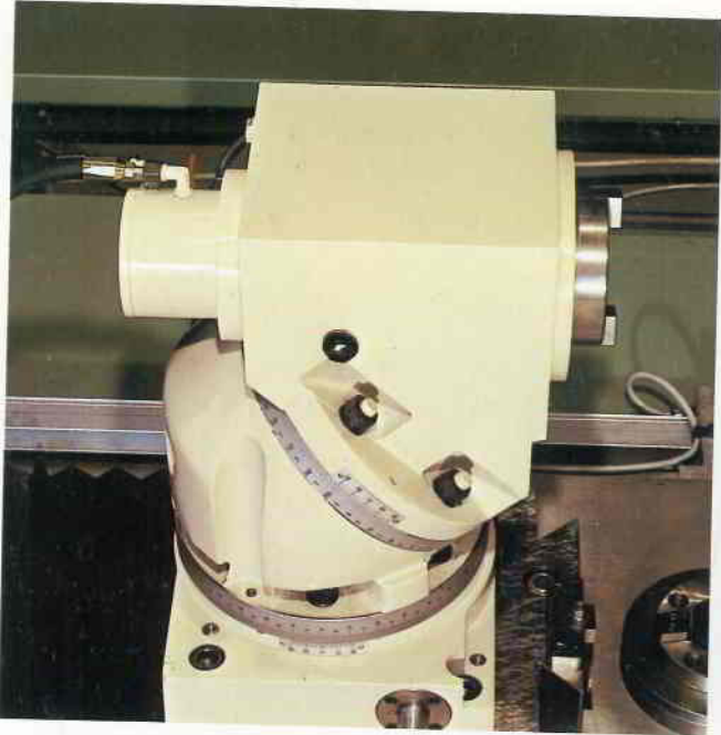
2 la testa a fresare universale frontale, che ha la possibilità di qualsiasi inclinazione
