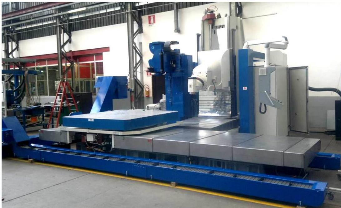
La Fresatrice TRT314 HS è una fresatrice di grandi dimensioni a banco fisso ad alta velocità equipaggiata con guide lineari a ricircolo di rulli su tutti i 3 assi e che presenta la struttura a “T” ormai universalmente riconosciuta, ideale per fornire prestazioni particolarmente spinte nella velocità di lavorazione.
