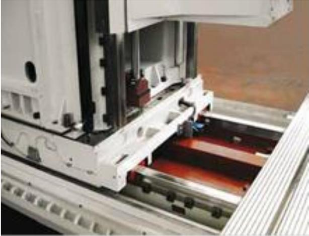
Il basamento in ghisa è nervato internamente in modo da ottenere un'elevata rigidità e la base portante della slitta Y è stata allargata per aumentare la stabilità della colonna.
