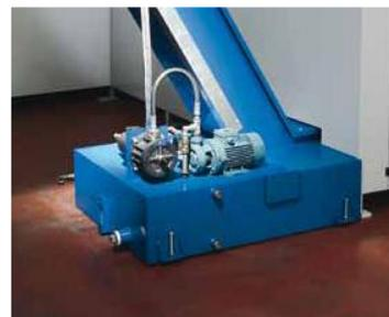
In alternativa è disponibile l'opzione refrigerante ad alta pressione **attraverso il mandrino** mediante una pompa con una pressione nominale di **40 bar**. La portata della pompa è regolabile mediante valvola con potenziometro in pulsantiera.
